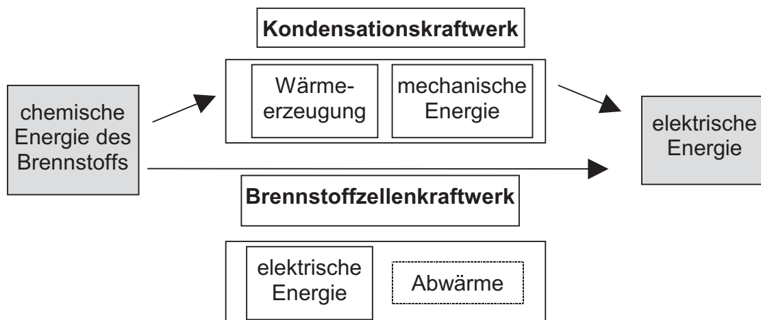
Abb. 2: Arbeitsweise einer Brennstoffzelle im Vergleich zur konventionellen Stromerzeugung
